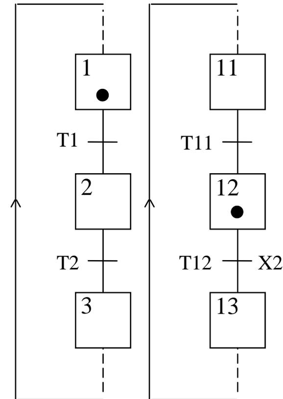
Il superamento della transizione T12 dipende dallo stato di attivazione della fase 2. L'evoluzione dello schema di destra si blocca in attesa di quello di sinistra.
