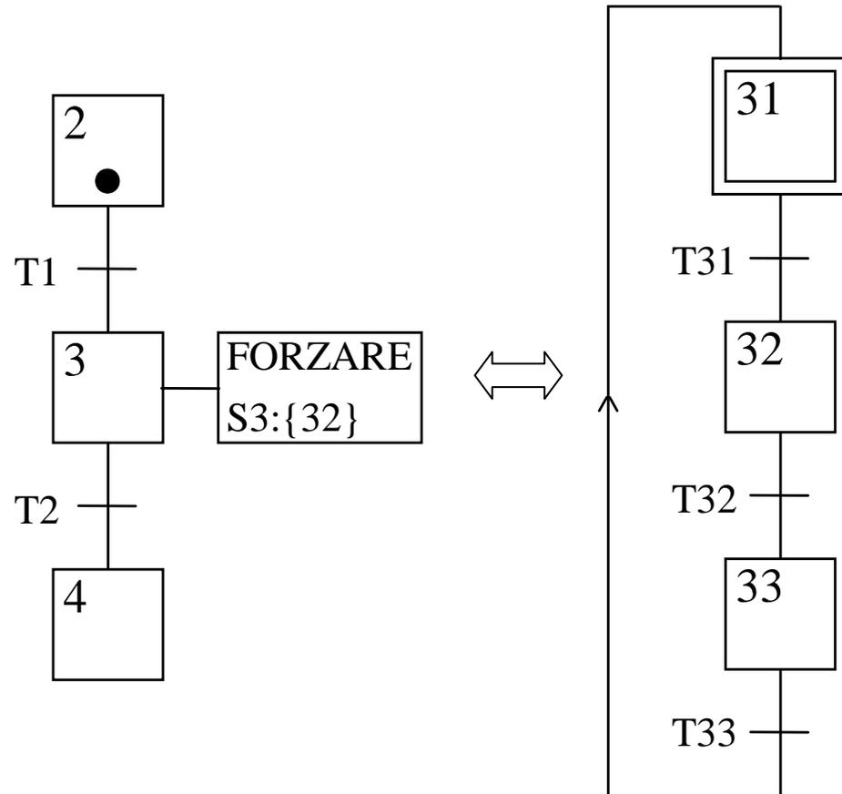
La macroazione del primo schema forza lo stato del secondo schema, attivando la fase 32.
